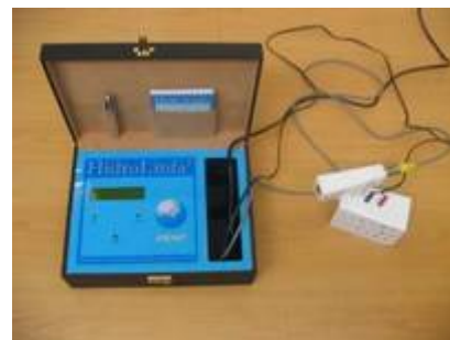
Fig. 4 Sensor Óptico y Electrodo con conexión total al Monitor
